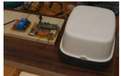
**28.1.2014** Heute hab ich den Positionsregler so umgelötet, dass er nur mehr mit einem OPV arbeitet, so wie in der rauschoptimierten LT-Spice Simulation. Der Photoverstärker arbeitet gleichzeitig auch als PI-Regler (in der Rückkopplung:  $150\text{k}\Omega + 1\mu\text{F}$ ).
