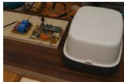
**28.1.2014** Heute hab ich den Positionsregler so umgelötet, dass er nur mehr mit einem OPV arbeitet, so wie in der rauschoptimierten LT-Spice Simulation. Der Photoverstärker arbeitet gleichzeitig auch als PI-Regler (in der Rückkopplung: 150kΩ + 1uF).
