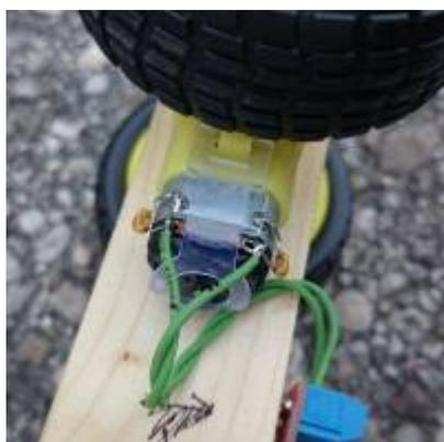
Beim Prototypen hat sich herausgestellt, dass die Kombination aus den Hochsetzstellern und den Motoren starke elektromagnetische Störungen verursacht, sodass sich der Mikrocontroller aufhängt, und nur mehr durch einen Reset wieder zur Vernunft gebracht werden kann. Als Abhilfe wurden mehrere Maßnahmen getroffen. Unter anderem wurden Entstörkondensatoren direkt an den Gleichstrommotoren angebracht, je zwei Stück pro Motor.
