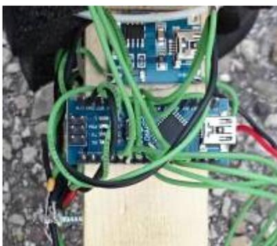
Als Herzstück, das all die Berechnungen und Steuerungen übernimmt, wird ein Arduino Nano verwendet. Man kann sich vorstellen, dass das ein ganzer Computer in klein ist. Er hat Ein- und Ausgabefähigkeiten, eine CPU (16MHz), Arbeitsspeicher (RAM, 2kByte) und quasi eine Festplatte (Flash-Speicher, 32kByte). Programmiert wird er über die USB-Schnittstelle. Auf dem PC braucht man die Arduino-IDE, um das Programm runterspielen zu können.
