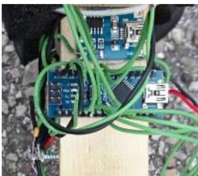
Als Herzstück, das all die Berechnungen und Steuerungen übernimmt, wird ein Arduino Nano verwendet. Man kann sich vorstellen, dass das ein ganzer Computer in klein ist. Er hat Ein- und Ausgabefähigkeiten, eine CPU (16MHz), Arbeitsspeicher (RAM, 2kByte) und quasi eine Festplatte (Flash-Speicher, 32kByte). Programmiert wird er über die USB-Schnittstelle. Auf dem PC braucht man das Arduino-Studio, um das Programm runterspielen zu können.
