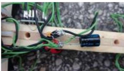
Die Stromverteilung zu all den verschiedenen Platinen erfolgt über einfache Schrauben, die als Lötstützen verwendet werden. Hier sind auch zwei Kondensatoren angebracht. Einerseits ein Aluminium-Elektrolyt-Kondensator zur Stützung der Spannungsversorgung bei Stromspitzen und außerdem noch ein kleiner Keramikkondensator zur Entstörung.
