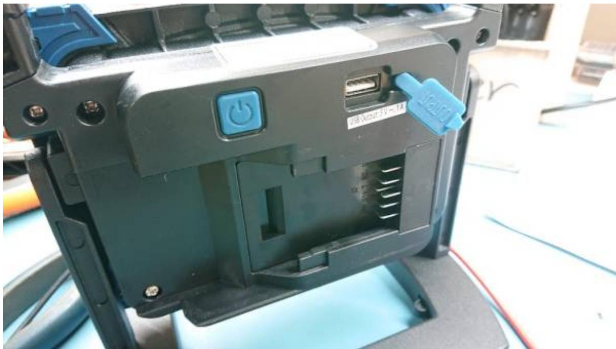
Die Tiefentladeschutzschaltung ist für die Batterielebensdauer kritisch und wurde hier sauber umgesetzt! Die Zellen werden bis 2.8V entladen. Eine Einzelpotenzialsüberwachung besteht bei den Akkus jedoch nicht! Der Reststrom von 5µA ist klein genug, dass auch ein entladener Akku noch einige Wochen im Gerät verbleiben kann.
