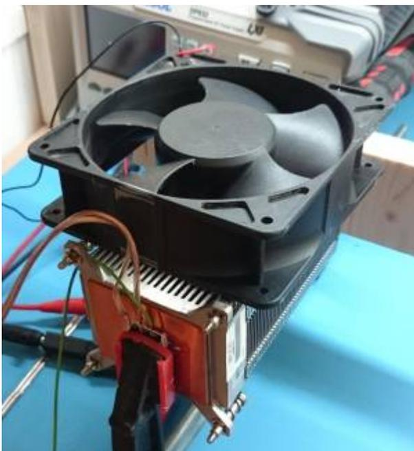
Mit Lüfter kommt man bei 86W auf etwa  $\Delta T = 10^\circ\text{C}$  (**0.116 K/W**).
